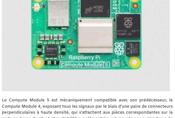
Le Compute Module 5 est mécaniquement compatible avec son prédécesseur, le Compute Module 4, exposant tous les signaux par le biais d'une paire de connecteurs perpendiculaires à haute densité, qui s'attachent aux pièces correspondantes sur la carte porteuse du client. Une stabilité supplémentaire est assurée par quatre trous de montage M2,5 disposés aux coins de la carte.
